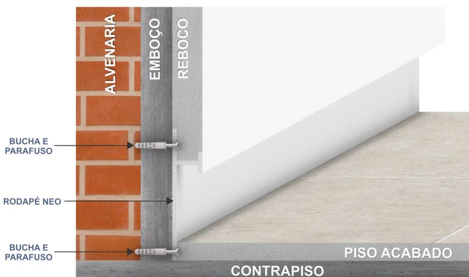
Corte esquemático da instalação do Rodapé Inverso Neo.
