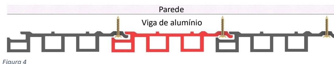
e) Ao final, caso haja necessidade, é possível refilar a última barra na largura necessária para finalizar o Ecoripado, parafusando a mesma pela parte do rebaixo do perfil.
