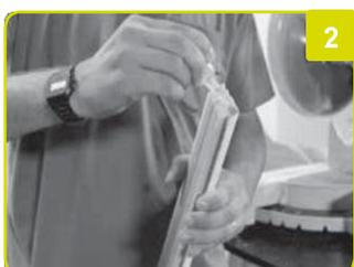
1. Antes de realizar cualquier corte, dejar los extremos de los zócalos y contramarcos en un ángulo de 90°. Realizar un corte en un ángulo de 45° con el zócalo en posición horizontal.
